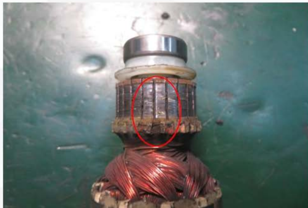
测试结束时换向器状态【转子烧毁】
