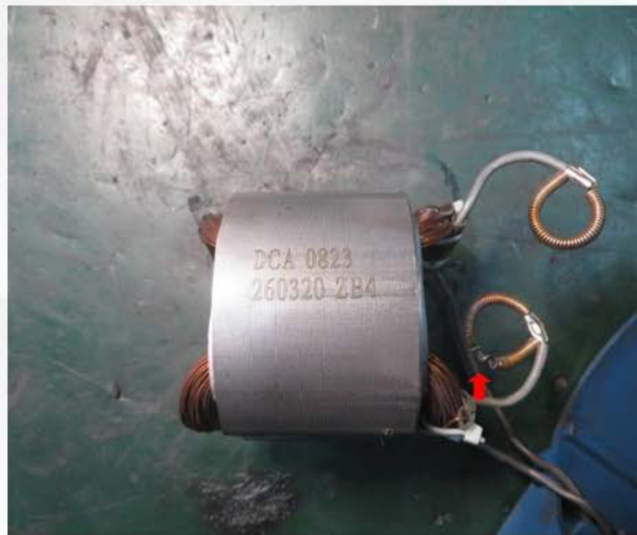
测试结束时定子耳簧变形状态
