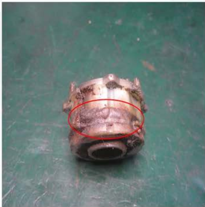
测试结束时减速箱后盖融化变形状态【②号机】。
