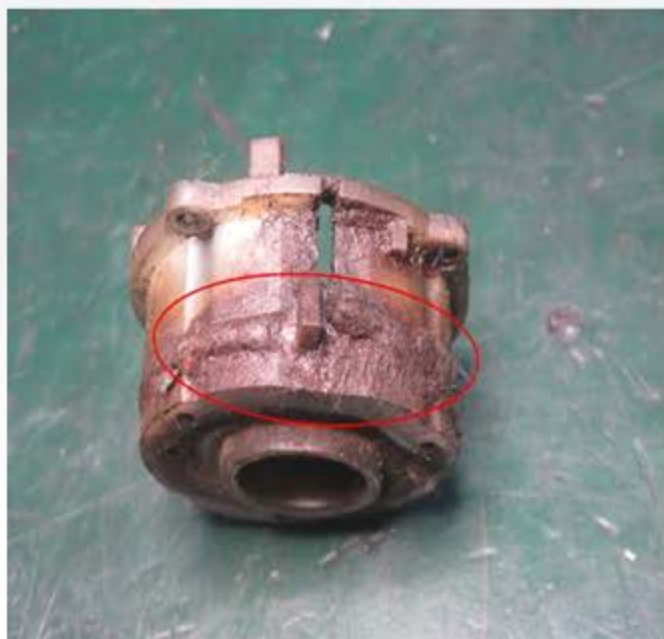
测试结束时减速箱后盖融化变形状态【①号机】。
